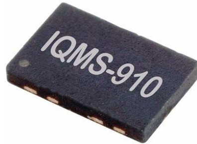
So kann ein bistabiler Schwinger als elektro-scher Baustein aussehen
