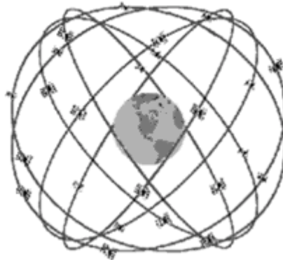
24 Satelliten in 6 Umlaufbahnen zu je 4 Satelliten in 20 200 km Höhe mit einer Neigung von 55^\circ gegen den Äquator.
