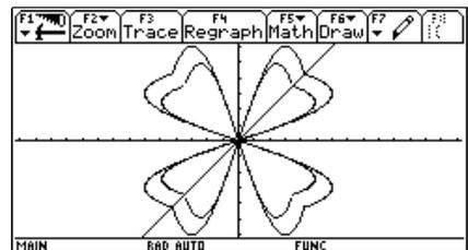
Die neue Funktionsgleichung lautet  $y(x) = -\frac{x^3}{6} + 3x$  und sie entsteht durch Stauchung um den Faktor  $k = \sqrt{2/3}$ . Die Umkehrrelationen können sehr elegant über die Parameterdarstellung durch Vertauschen von Argument und Funktionswert gezeichnet werden.
